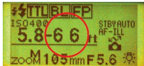
Abbildung 3.36: Wenn Sie den Blitzreflektor zoomen, ändert sich die Blitzreichweite. Beachten Sie, dass bei einer Brennweite von 24 mm der Blitz nur bis zu einer Entfernung von 11 m genutzt werden kann (hier angezeigt als 35 ft). Zoomen Sie dagegen auf 105 mm ein, so kann er bis zu einer Entfernung von 20 m (in der Abbildung angegeben als 66 ft) genutzt werden.
