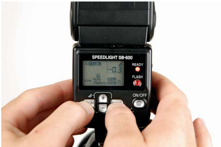
Abbildung 3.34: Wenn Sie nicht schnell genug hinschauen, ist die Anzeige der Unterbelichtung schon wieder verschwunden. In diesem Fall drücken Sie einfach beim SB-600 gleichzeitig die beiden Tasten ZOOM und MODE (hier abgebildet), beim SB-800 die Tasten MODE und SEL oder beim SB-900 die Funktionstaste 2.
