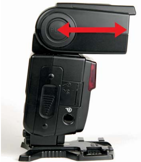
Abbildung 3.35: Wenn Sie die Brennweite Ihres Objektivs verändern, wird gleichzeitig auch der Blitzreflektor gezoomt. So ist sichergestellt, dass der Bildwinkel des Objektivs identisch mit dem vom Blitzlicht ausgeleuchteten Bereich ist.
