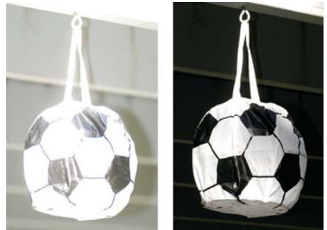
Abbildung 3.19: Die linke Aufnahme zeigt, was passiert, wenn die Belichtungszeit eigentlich kürzer als die kürzeste Synchronzeit sein müsste. In diesem Fall wurden die Fotos mit einer D70 aufgenommen, die als kürzeste Synchronzeit ein 1/500 Sekunde hat. Der Fußball, der als Dekoration bei einer Geburtstagsfeier diente, hing im direkten Sonnenlicht. Das Bild wurde bei Blende 2,8 aufgenommen und für die Belichtung wurde »Hi« angezeigt. Das bedeutete, dass das Umgebungslicht zu hell für eine Belichtungszeit von 1/500 Sekunde war. Die Kamera konnte trotzdem ausgelöst werden, aber wie Sie sehen, ist das Foto völlig überbelichtet. Das nächste Bild wurde bei Blende 14 mit einer Belichtungszeit von 1/320 Sekunde aufgenommen. Nun ist das Foto in Ordnung und gut belichtet. Fazit: Achten Sie auf die Belichtungszeit und stellen Sie sicher, dass sie nie kürzer als die kürzeste Synchronzeit Ihrer Kamera ist.
